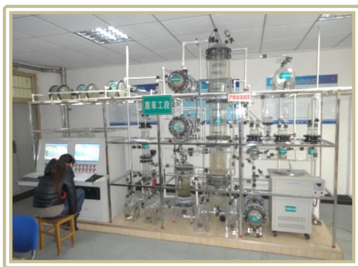
图 12 安全智能化的全玻璃仿真焦炉煤气净化教学工厂
